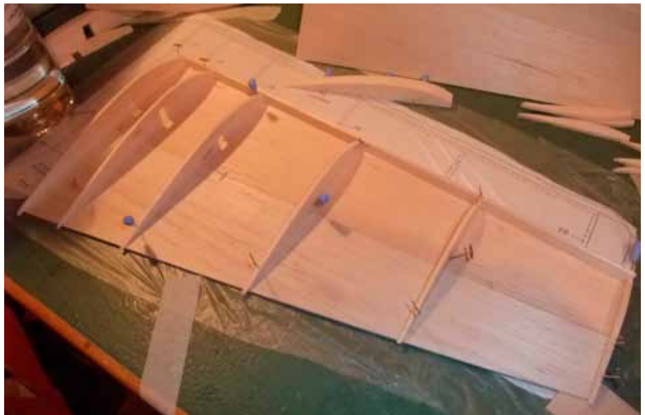
Spryglarna och framkant limmas
